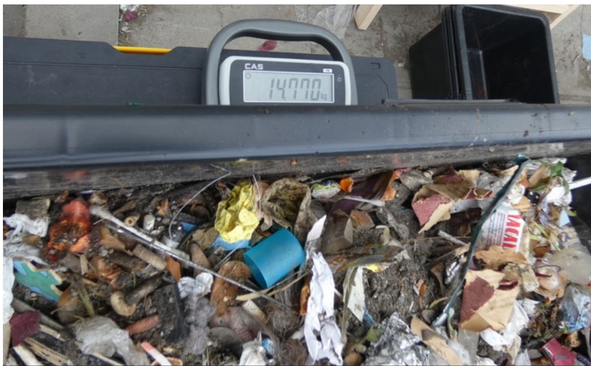
Obrázek 13: Vzorek 3 - podíl pod 40 mm
