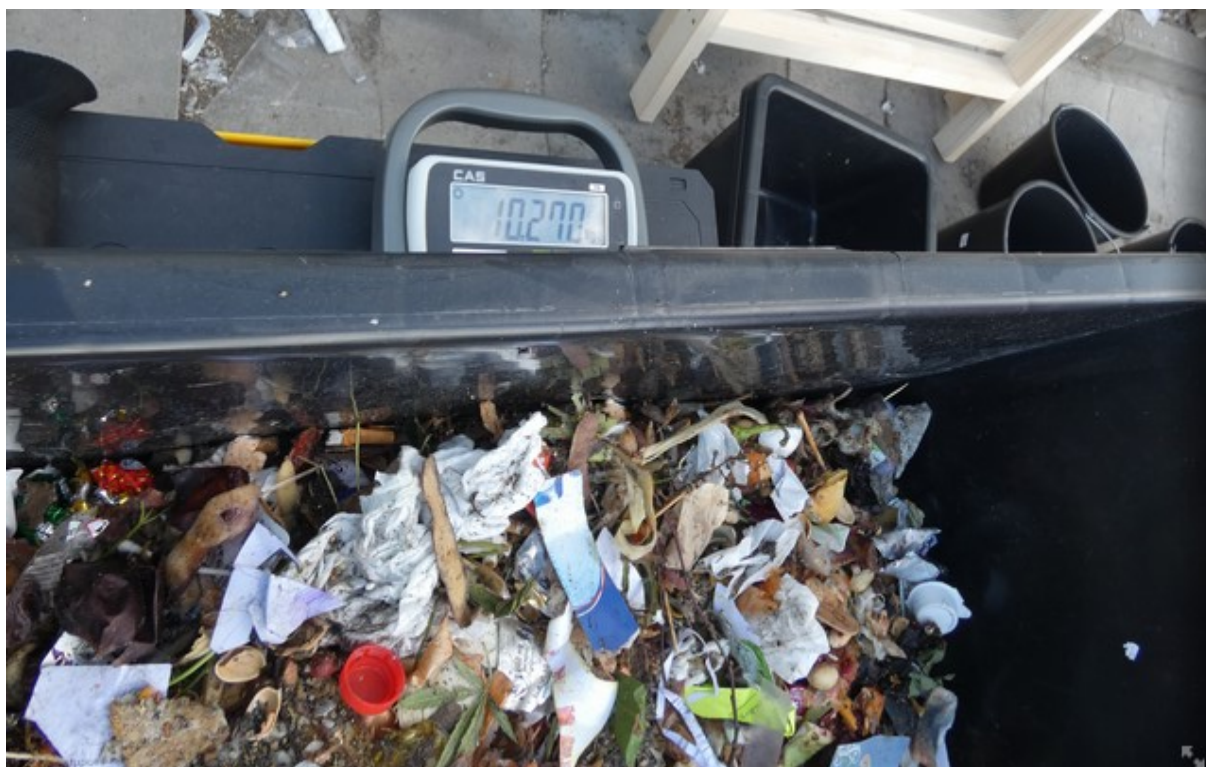
Obrázek 9: Vzorek 1 - podíl pod 40 mm
