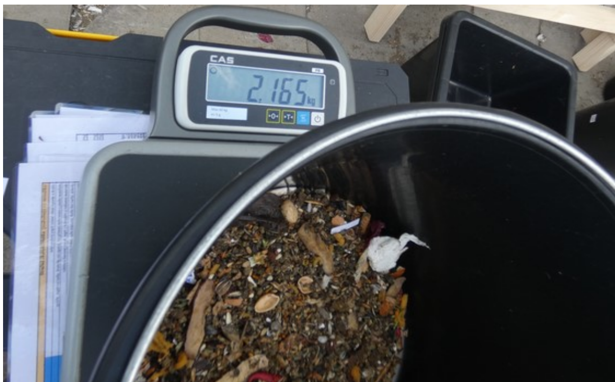
Obrázek 10: Vzorek 1 - podíl 0 - 10 mm
