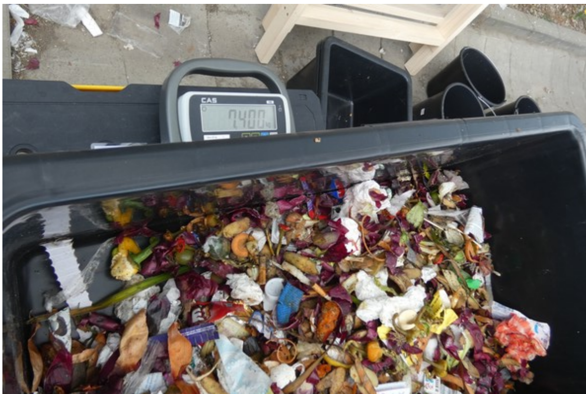
Obrázek 12: Vzorek 2 - podíl 20 - 40 mm, první část jemného podílu
